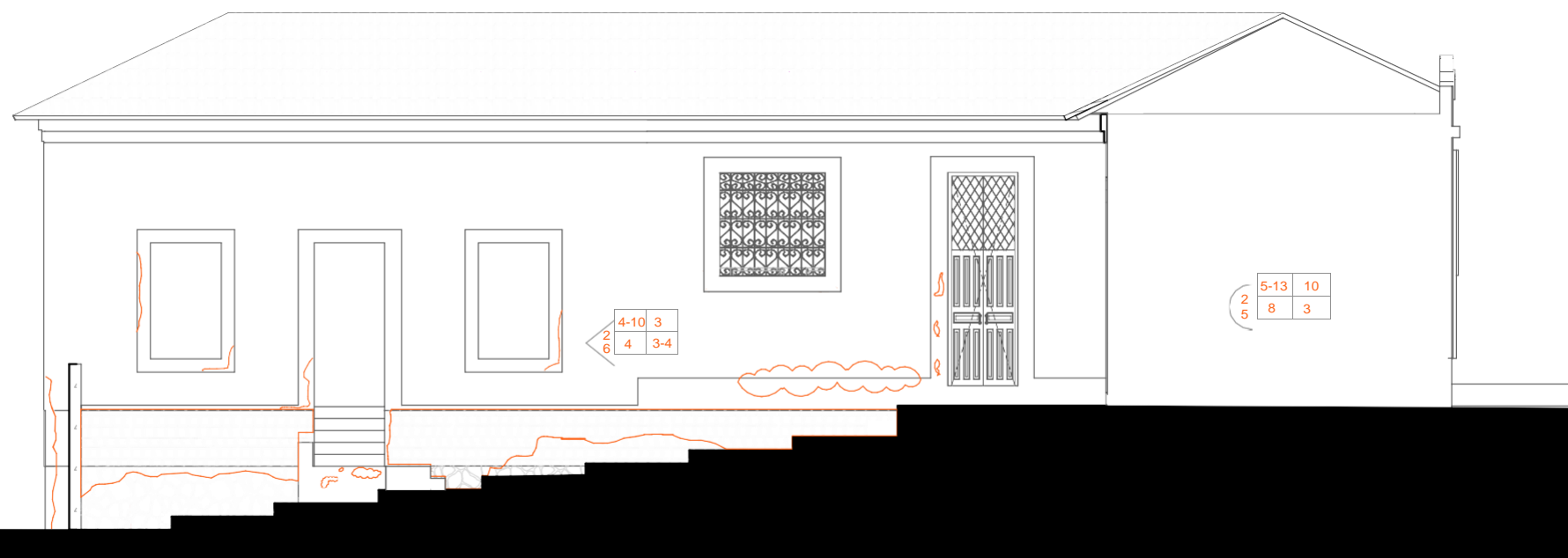
SO | FACHADA LATERAL IZQUIERDA - PATOLOGIAS ESC:1:100
