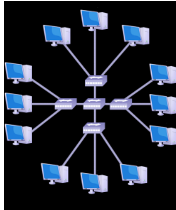
Ilustración 4 - Topología estrella extendida
