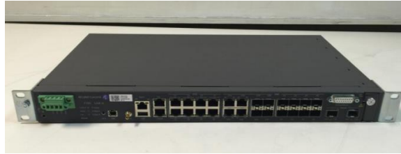
Figura 5 Equipo Nokia Alcatel-Lucent 7705 sar-x Fuente: (FCCID.io, 2017)
