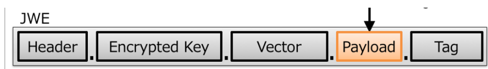
Imagen 2 Estructura JWT Encriptado
