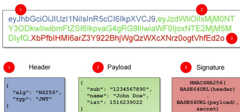
Imagen 1 Estructura JWT Firmado
