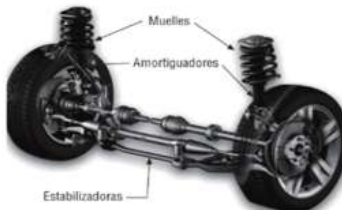
Imagen 8: Elementos de la suspensión. Fuente: Picabea, Zubía & Ortega, (2010).
