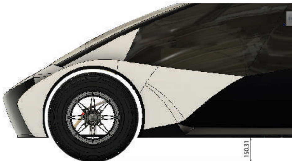
Imagen 81: Altura del vehículo en mm desde la calzada al piso del vehículo Fuente: (Vaca, José, 2018)
