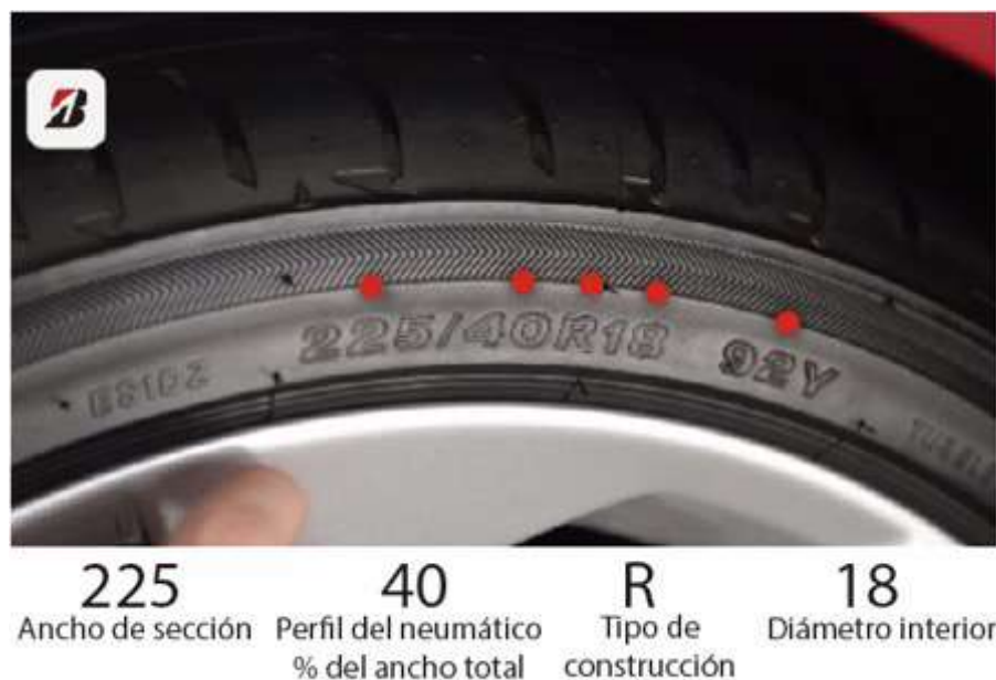
Imagen 48: Como leer una llanta. Fuente: Bridgestone, (2020).
