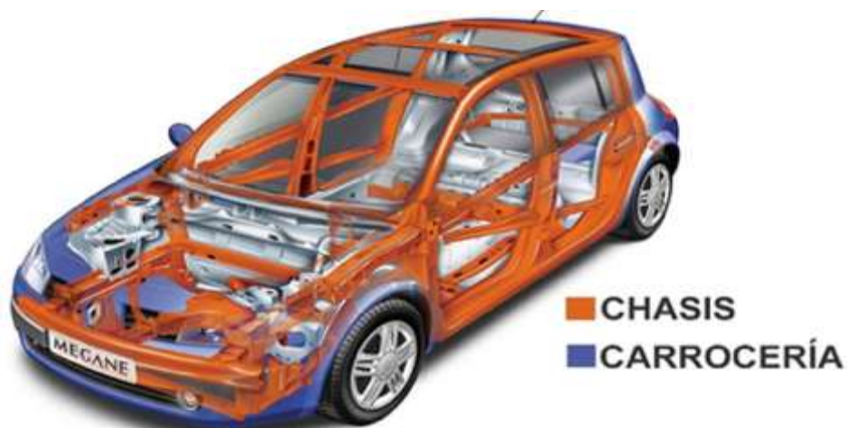
Imagen 6: Diferencia entre chasis y carrocería. Fuente: Nitro, (2015).
