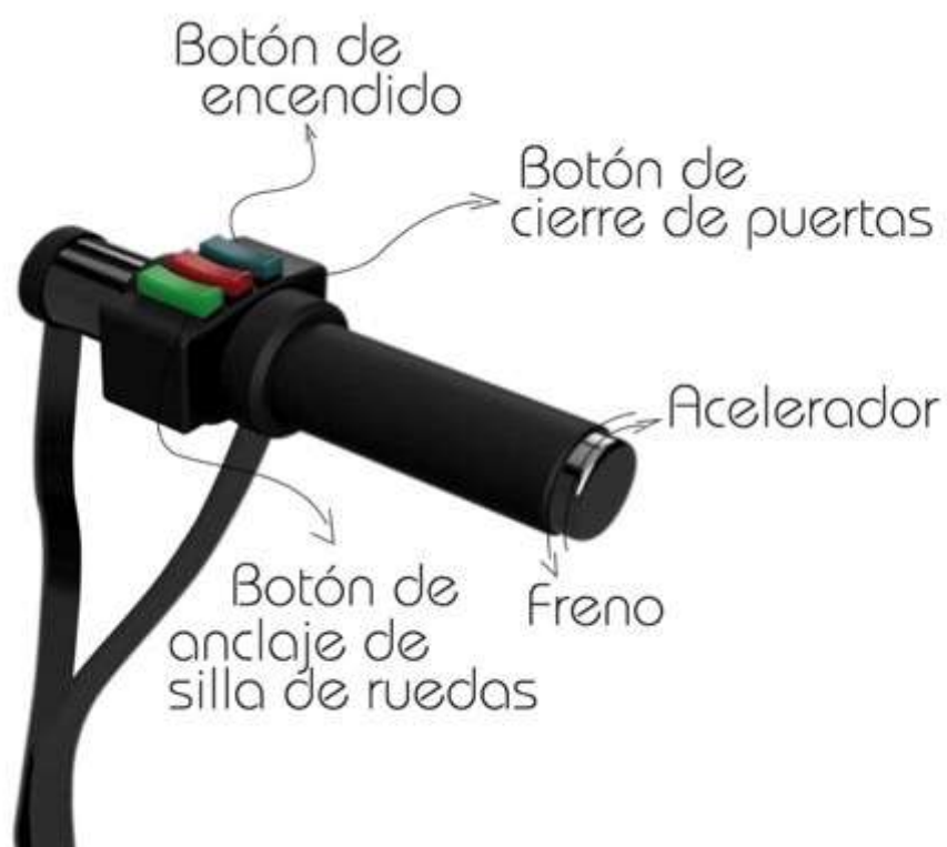
Imagen 69: Mando de aceleración y freno modelo N°1. Fuente: (Vaca, José, 2018)
