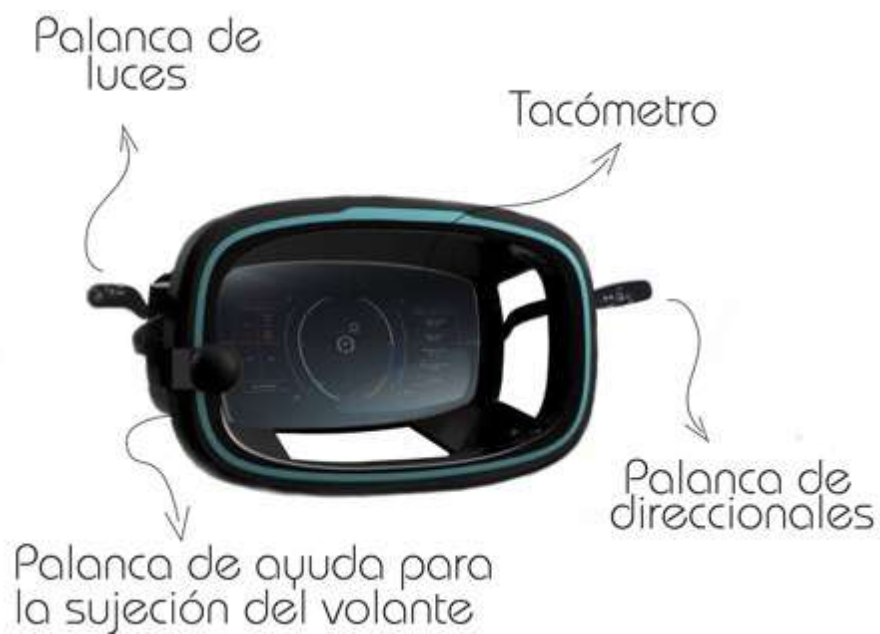
Imagen 68: Mando de conducción modelo N° 1. Fuente: (Vaca, José, 2018)
