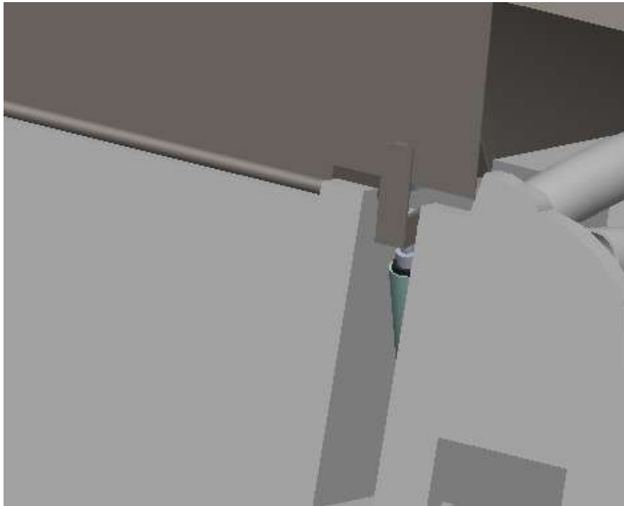
Imagen 79: Sistema de apertura de puerta inferior con pistón de elevación. Fuente: (Vaca, José, 2018)
