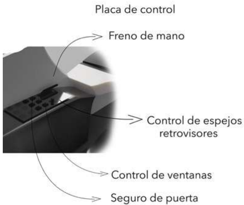
Imagen 80: Placa de comandos adicionales modelo N°1. Fuente: (Vaca, José, 2018)
