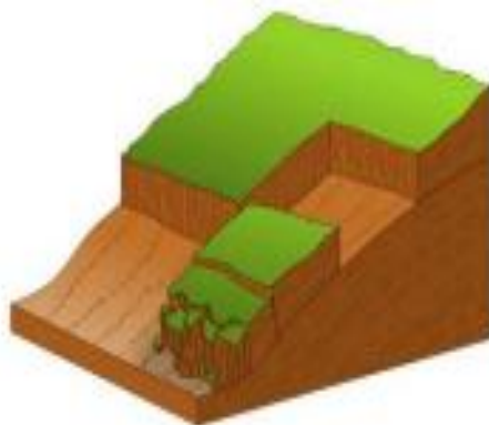
3 Figura: Deslizamiento (Varnes, 1978)
