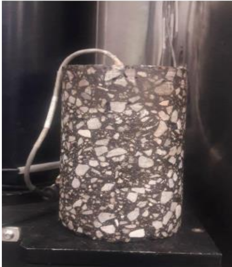
Fotografía 3.3.1: Espécimen con termocople para monitorear la temperatura del espécimen de ensayo. Fuente:(Alamilla & Flores, 2017)
