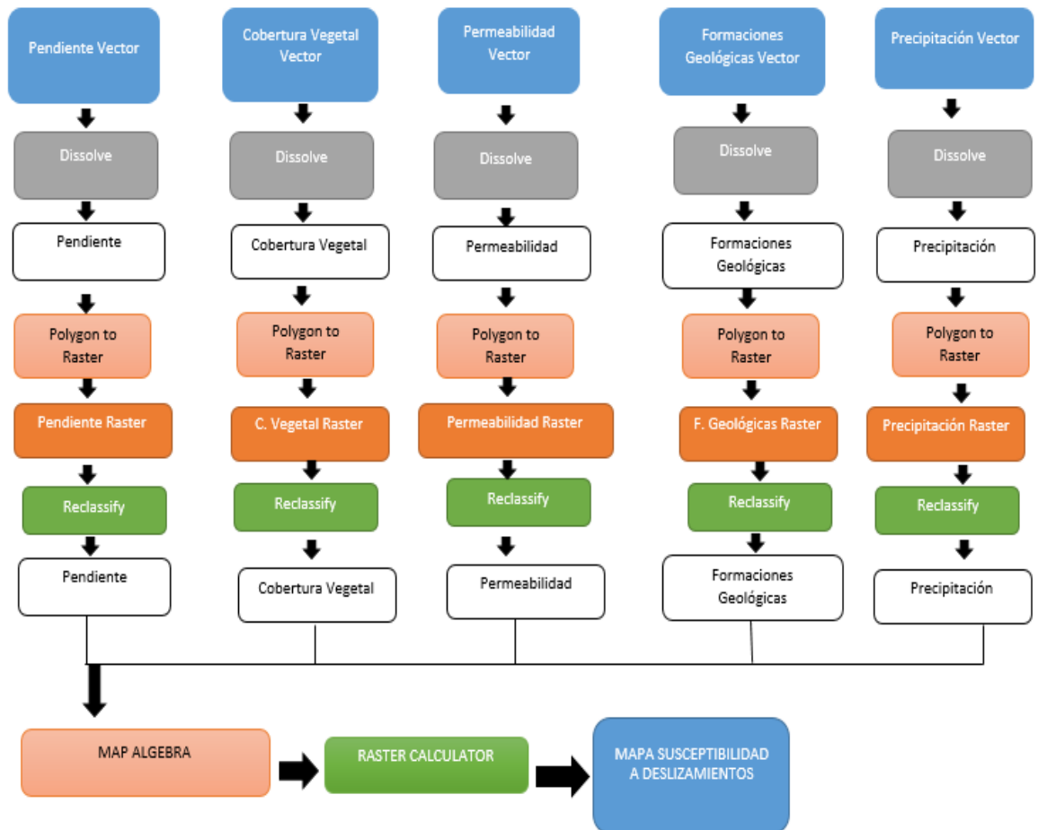
Figura 17. Diagrama de elaboración del mapa de susceptibilidad a deslizamientos. Fuente y elaboración: el Autor.
