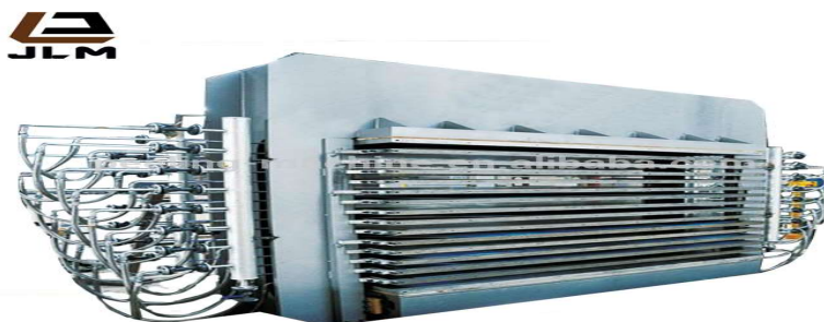
Figura 34: Máquina de prensado en caliente JINLUN/JLM (GADSANTACRUZ, 2020)
