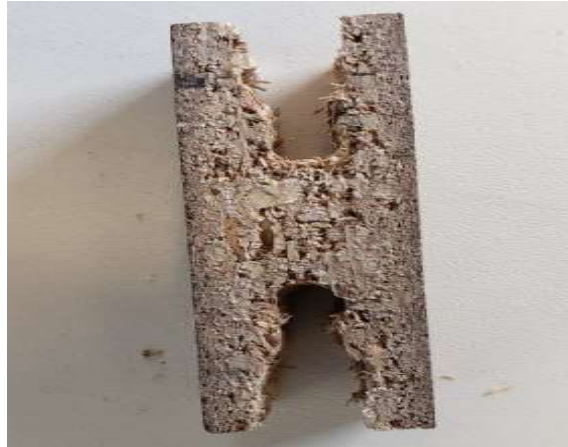
Figura 30: Pieza para ensayo de la resistencia de tracción perpendicular a las caras (David Proaño, 2020)
