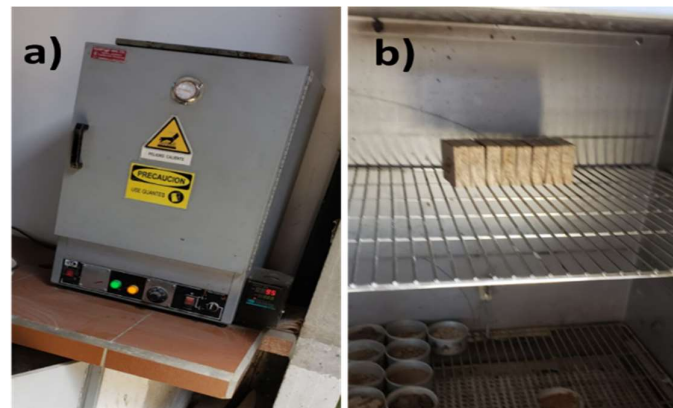
Figura 28: Proceso de secado. a) estufa de secado, b) Probetas de ensayo en la estufa a 103 °C
