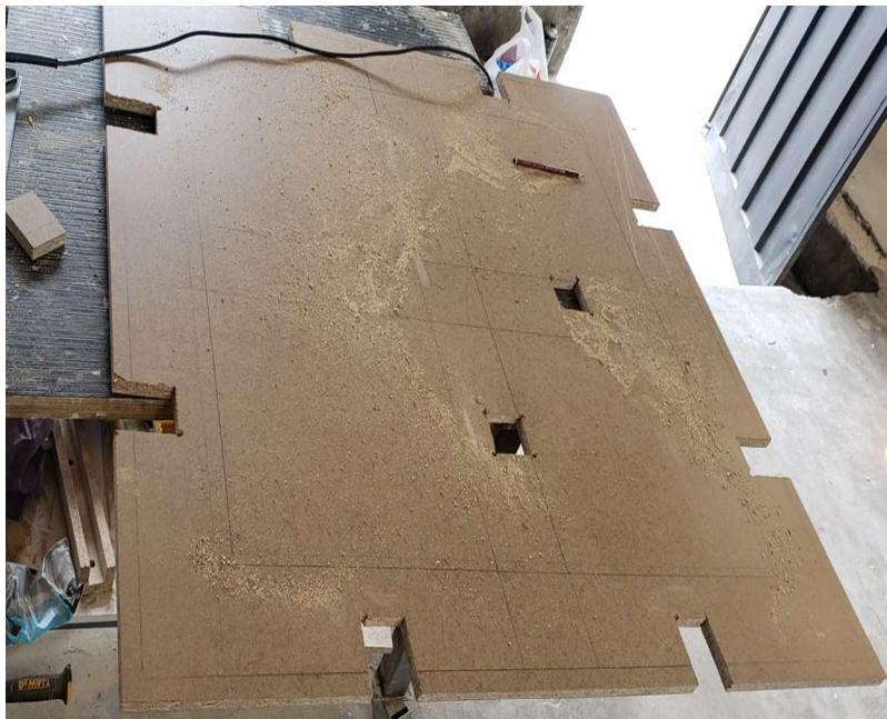
Figura 25: Toma de probetas de ensayo de un tablero aglomerado (David Proaño, 2020)
