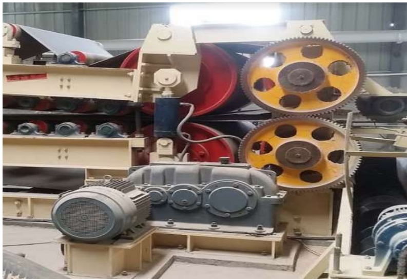
Figura 19: Máquina prensadora de tableros. Novopan S.A. (David Proaño, 2020)
