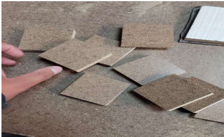
Figura 26: Probeta de ensayo obtenidas de un tablero aglomerado (David Proaño, 2020)
