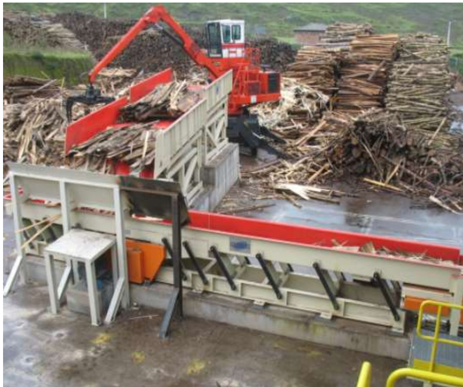
Figura 16: Proceso de descortezado y triturado Novopan S.A. (David Proaño, 2020)
