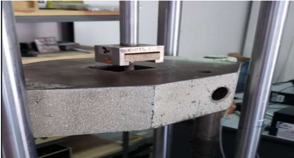
Figura 33: Pieza colocada en las mordazas del dinamómetro para obtener su carga de rotura (David Proaño, 2020)
