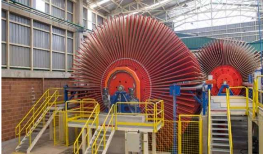
Figura 22: Máquina de enfriamiento de tableros aglomerados. Novopan S. A. (David Proaño, 2020):
