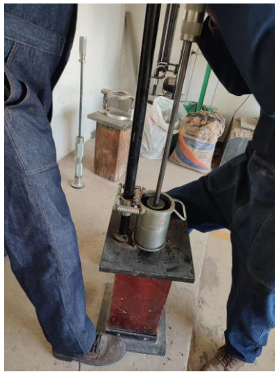
Ilustración 4.9 Máquina compactadora Marshall
