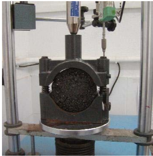
Ilustración 4.5 Briqueta fijada en máquina de ensayo
