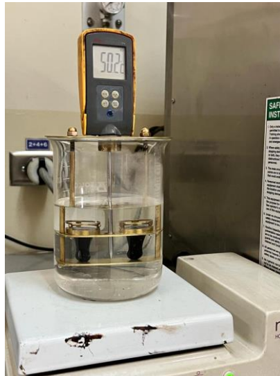
Ilustración 3.5 Ensayo de Anillo y Bola
