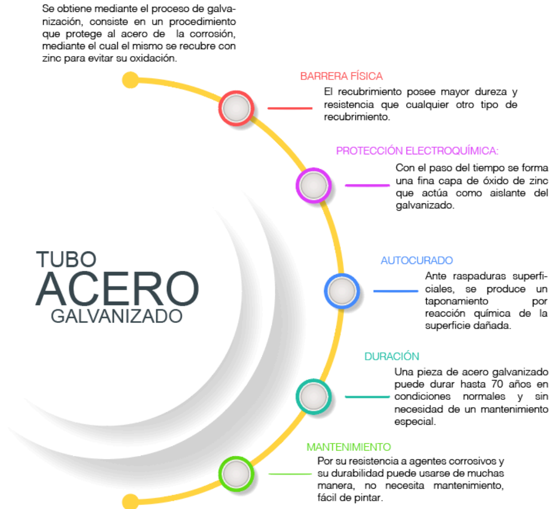
Imagen 2.8 Análisis de materiales tubos de acero.
