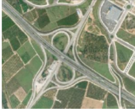
Ilustración 2. 3: Intercambiador tipo “Trébol de dos hojas opuestas”.
