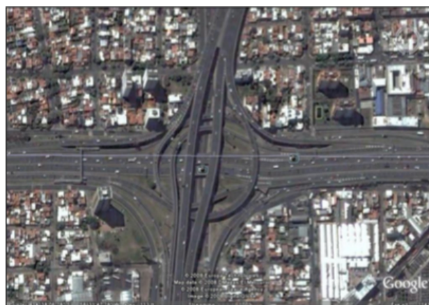
Ilustración 2. 6: Intercambiador tipo “Mayor con ramas directas e indirectas”.
