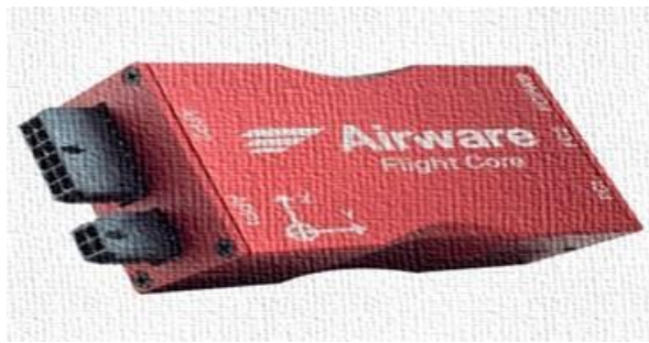
Ilustración 34 La caja de núcleo de vuelo de Airware se conecta a los sensores y a los controles físicos del dron para que el aparato pueda ejecutar desde la tierra y enviar de vuelta los datos recogidos
